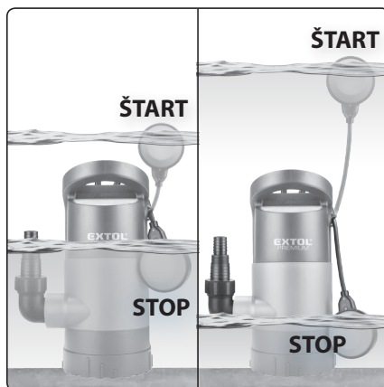
Obr. 4, ilustrácia funkcie plavákového spínača
